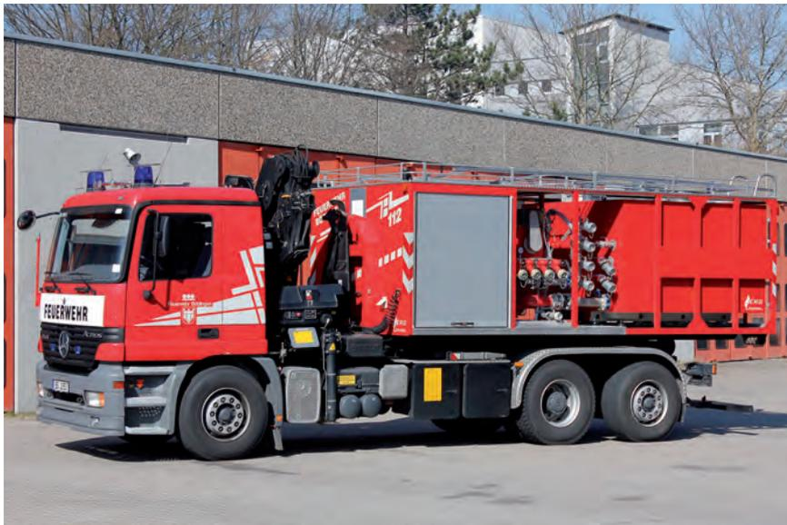
Der Abrollbehälter »Sonderlöschmittel« der Feuerwehr Böblingen ist auf einem WLF des Typs Mercedes-Benz Actros 2540, Baujahr 2001, aufgesattelt. Gut zu erkennen sind in der Behältermitte die Zu- und Abgänge der FireDos-Zumischanlage sowie der Feuerlöschkreislumpe.
