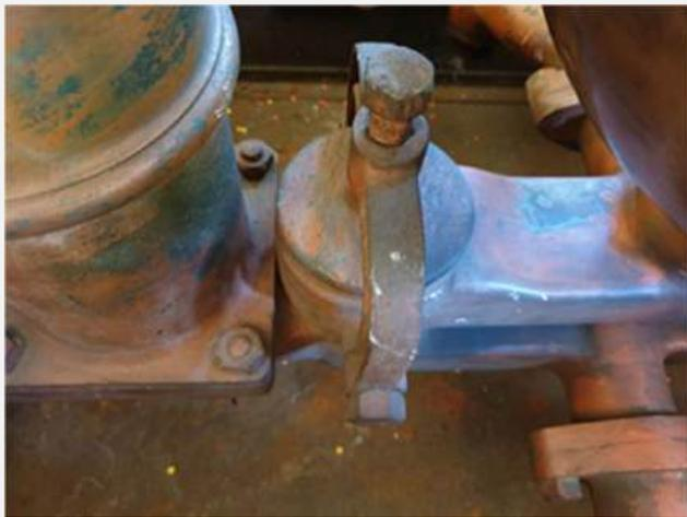
eine der beiden Ventilkammern – mit Schraubbügelverschluss
