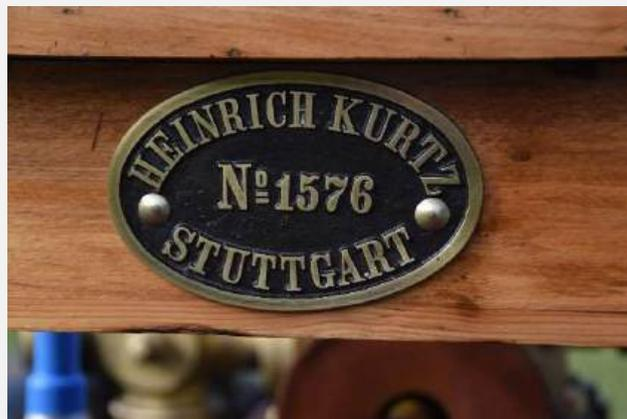
Herstellerschild - geprägt mit Fabrikationsnummer am Gerätekasten vorn
