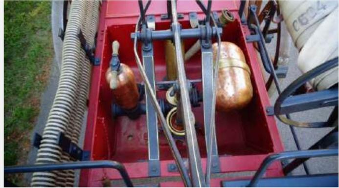
Pumpwerk - Ventilkammer mit Ewald- Schnellverschlussbügel
