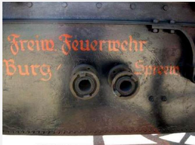
2 Druckabgänge System Storz 52mm (C) /Beschriftung Wasserkasten linksseitig
