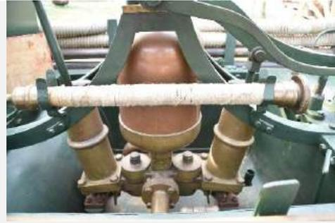
Pumpwerk- Ventilkammern einzeln verschraubt
