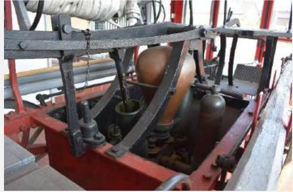
Pumpwerk- Ventilkammern mit Moment- (Schnell) Verschluss, Saugwindkessel- umstellbar mit Wirbel
