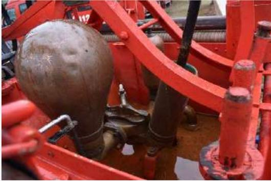
Pumpwerk - Ventilkammer mit Ewald-Schnellverschlussbügel (neue Bauart)
