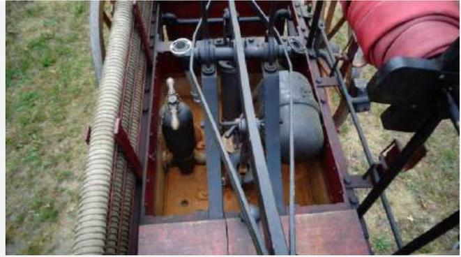
Pumpwerk - Ventilkammer mit Ewald- Schnellverschlussbügel und Herstellerprägung
