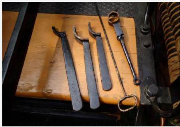
Zubehör Kupplungsschlüssel, Ventilschlüssel, Dorn
