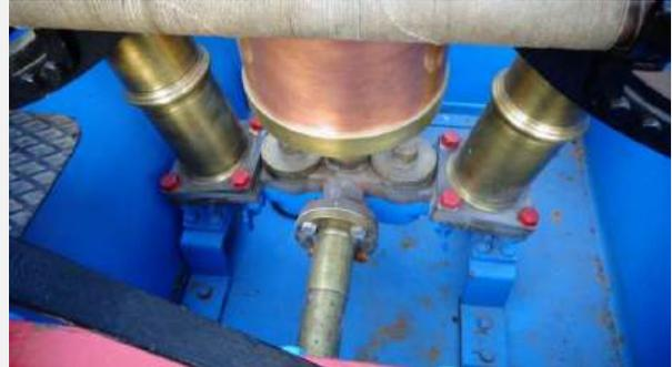
Pumpwerk – Ventilkammern einzeln verschraubt, Saugwindkessel- umstellbar mit Wirbel
