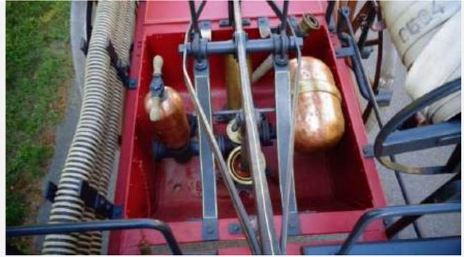
Pumpwerk - Ventilkammer mit Ewald- Schnellverschlussbügel
