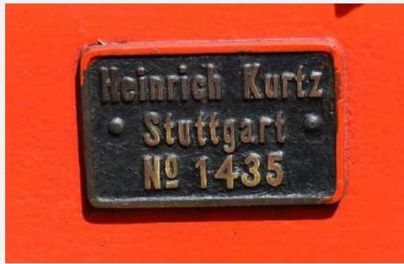
Herstellerschild - geprägt mit Fabrikationsnummer am Wasserkasten vorn
