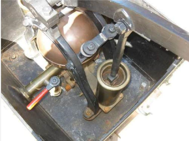
Pumpwerk – druckseitig – Zentral-Ventilkegel mit Schnellverschluss unterhalb Druckstutzen
