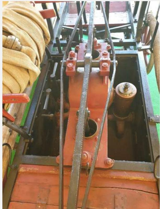
Pumpwerk – auf der Druckseite (links), die Abstellorgane der beiden Druckanschlüsse
