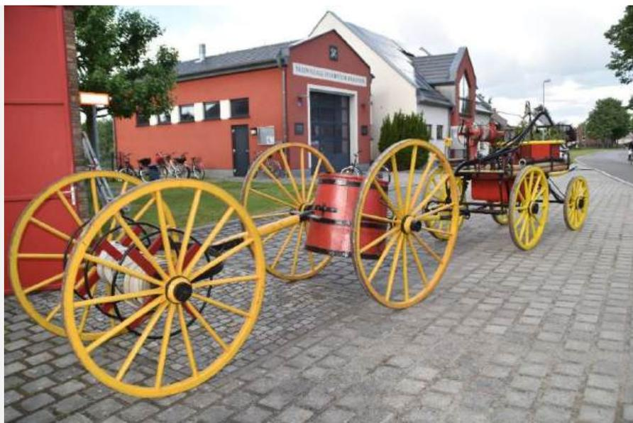
Kompletter Zug – Spritze, Wasserwagen, Schlauchwagen
