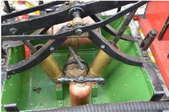
Pumpwerk - Ventilkammer mit Ewald-Schnellverschlussbügel
