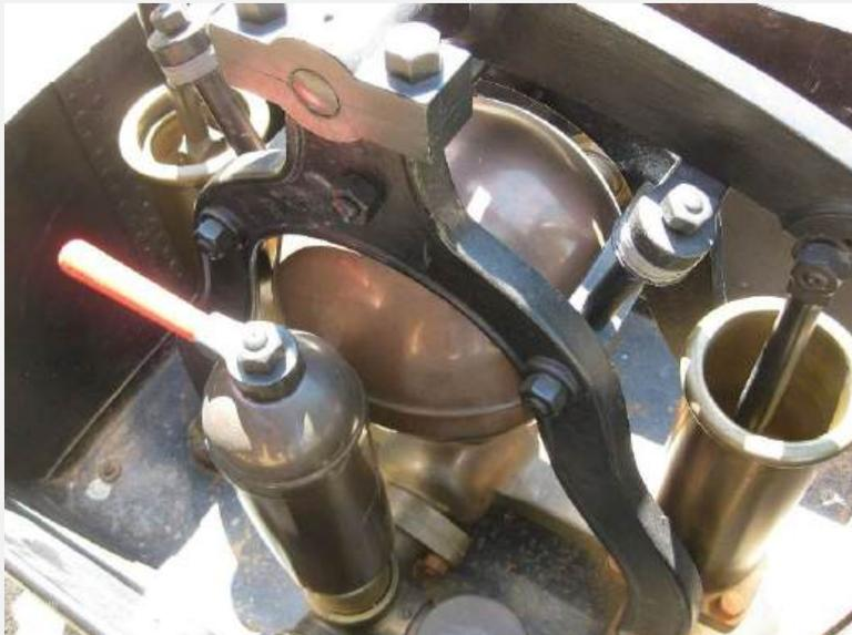
Pumpwerk – saugseitig – Zylinderstellung senkrecht – Umstellhahn am Saugwindkessel
