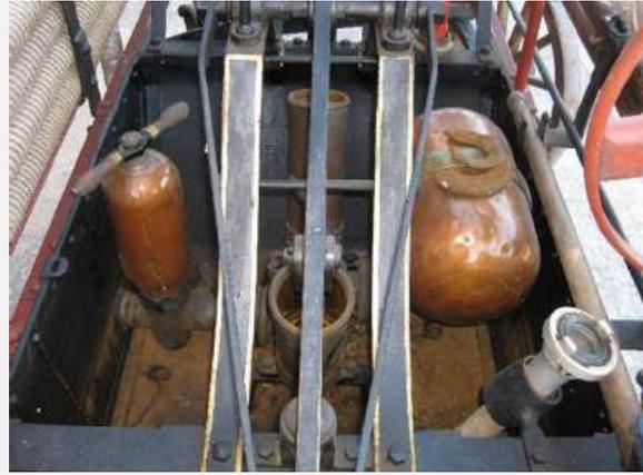
Pumpwerk - Ventilkammer mit Ewald- Schnellverschlussbügel / Druckwindkessel- liegend
