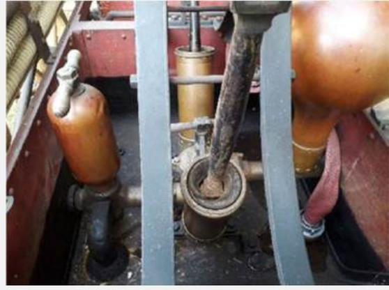
Pumpwerk - Ventilkammer mit Ewald- Schnellverschlussbügel / Druckwindkessel- stehend- birnenförmig
