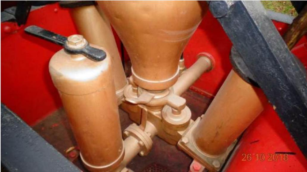
Pumpwerk- (Ventilkammern mit Moment- (Schnell-) Verschluss
