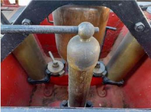
Pumpwerk – saugseitig – Ventile einzeln mit Schnellverschraubung
