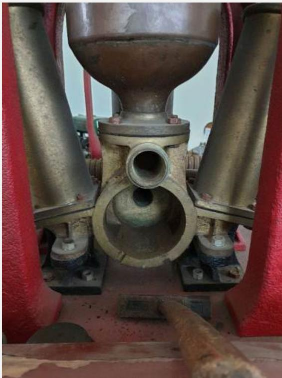
Pumpwerk – Ventilkammer (unten) geöffnet /
