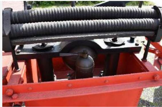
Pumpwerk – saugseitig – Zylinderstellung senkrecht – Umstellhahn am Saugwindkessel
