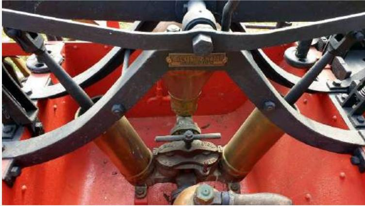
Pumpwerk- Ventilkammer mit Ewald- Schnellverschlussbügel neuere Bauart
