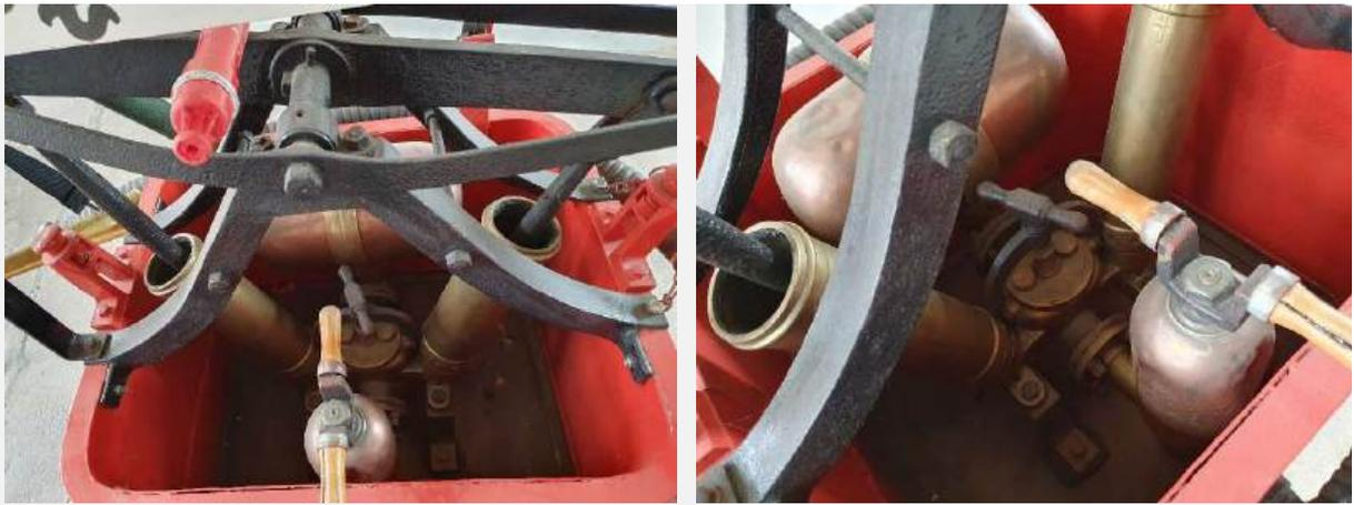
Pumpwerk - Ventilkammer mit Ewald- Schnellverschlussbügel
