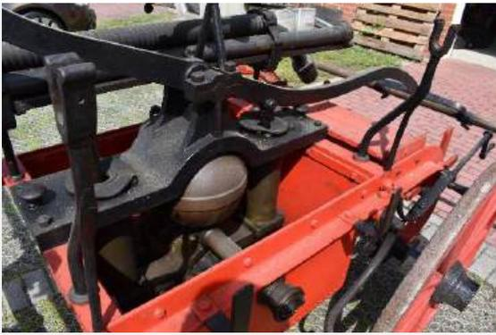
Pumpwerk – druckseitig – Zentral- Ventilkegel mit Schnellverschluss unterhalb Druckstutzen
