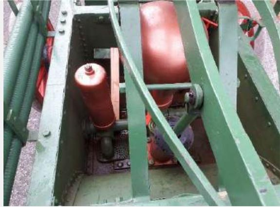
Pumpwerk- (Ventilkammern mit Moment- (Schnell-)Verschluss)
