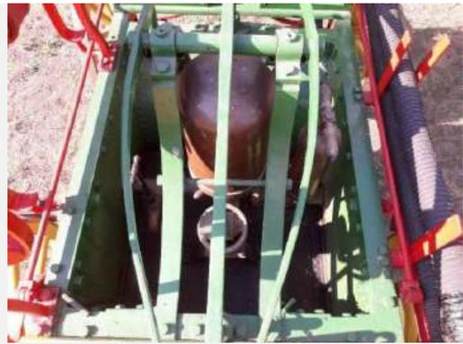
Pumpwerk (Ventilkammern mit Schnellverschluss) , Saugwindkessel umstellbar mit Wirbel, Druckwindkessel zylinderförmig)
