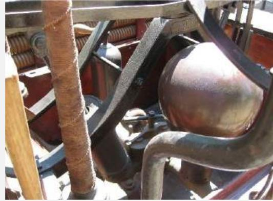
Pumpwerk - Ventilkammer mit Ewald- Schnellverschlussbügel (neue Bauart) /
