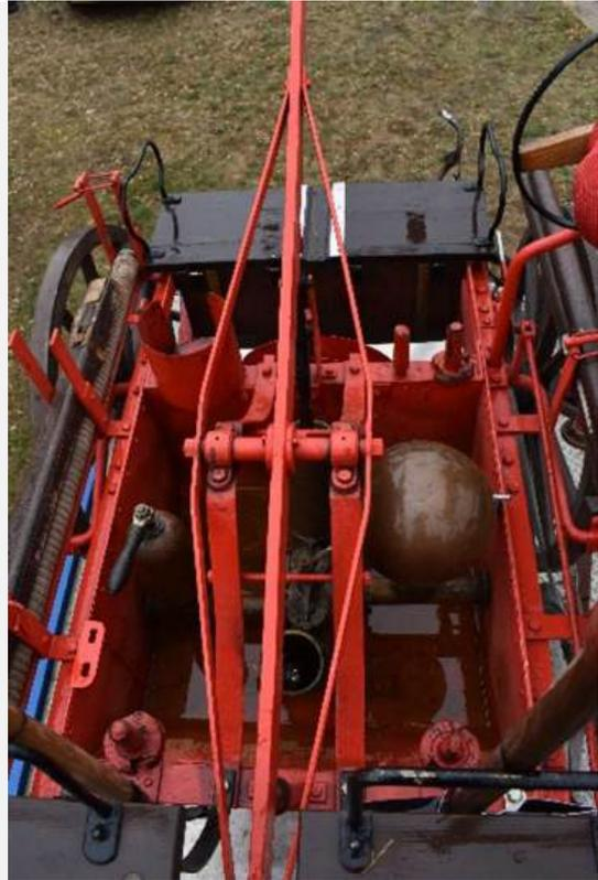
Druckwindkessel- stehend- birnenförmig
