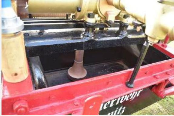
Pumpwerk – druckseitig – Zentral- Ventilkegel mit Schnellverschluss unterhalb Druckstutzen (rund)
