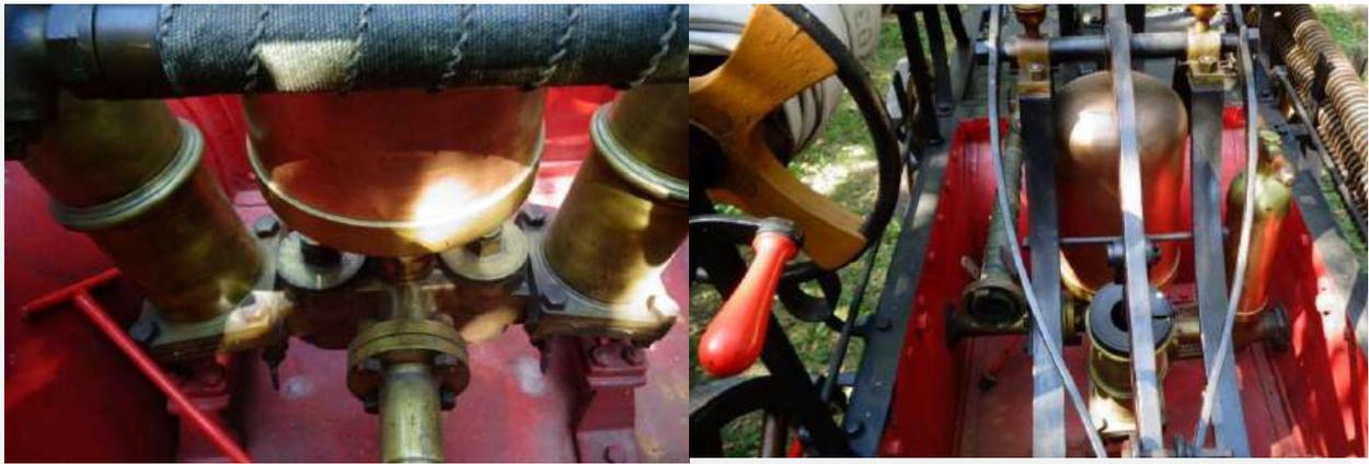
Pumpwerk- Ventilkammern einzeln verschraubt) , Saugwindkessel- umstellbar mit Wirbel, Druckwindkessel- zylinderförmig , Zubehör Strahlrohr/ Saugschläuche
