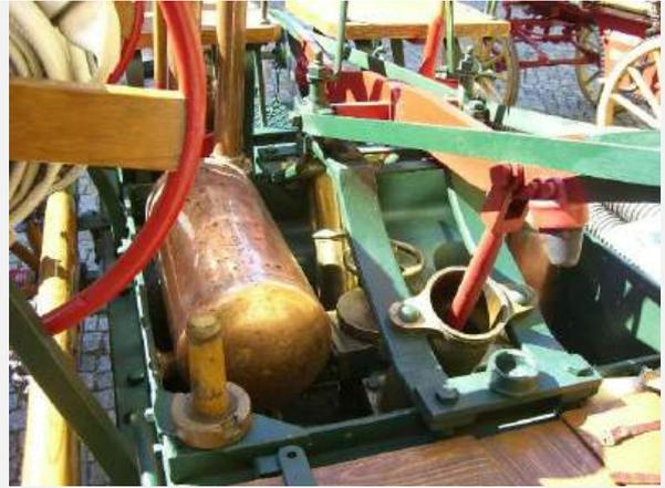
Pumpwerk saugseitig- Ventilkammer mit Bräunert – Patent- Schnellverschluss / Druckwindkessel - liegend
