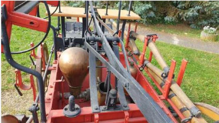
Druckwindkessel- stehend- birnenförmig
