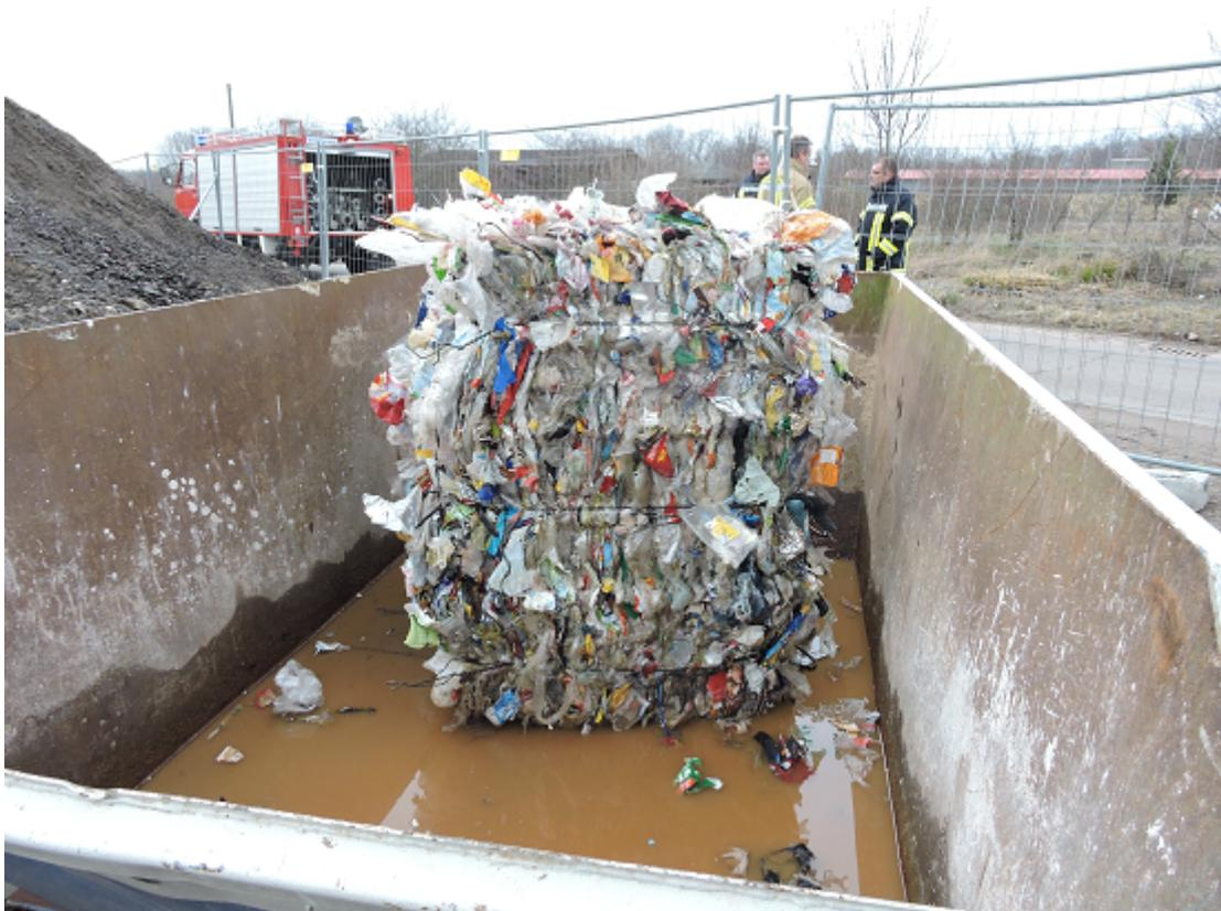
Mit einer Fackel wurde der Ballen mit gepressten Kunststoffteilen angezündet und ca. 8 Minuten brennen gelassen.
