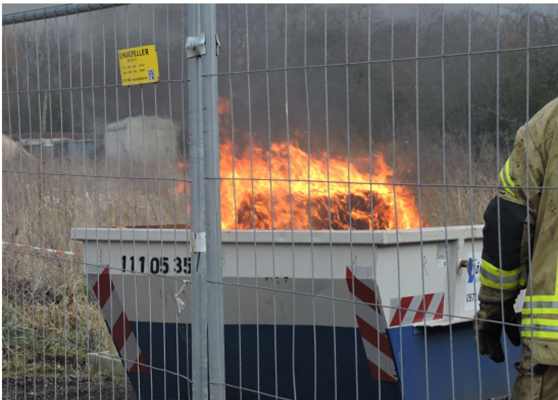
Danach wurde mit dem AWG-Löschgerät für F-500 gelöscht Zumischung 0,5 % F-500.
