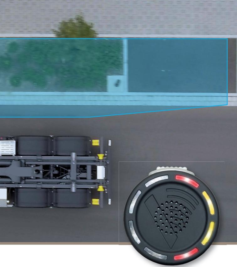
Über das LED-Display an der A-Säule wird der Fahrer optisch gewarnt. Bei aktiviertem Blinker erfolgt zusätzlich eine akustische Warnung.
